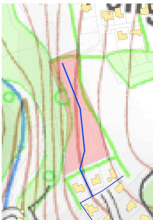
Figure 34 : raccordement du secteur de Traon Beuzit au futur réseau de collecte des eaux usées
