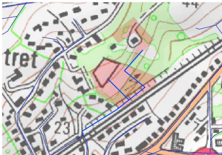
Figure 30 : raccordement du secteur de l'Allée du Chemin de Fer au futur réseau de collecte des eaux usées
