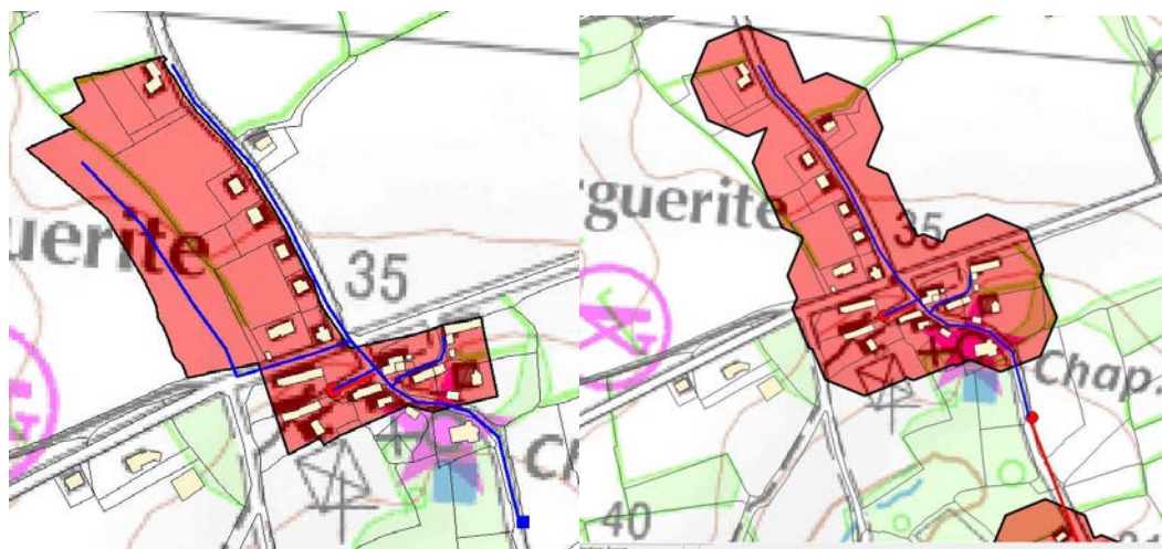
Figure 94 : scénarios "assainissement collectif" du secteur de Saint Marguerite avec à gauche : construction d'une station d'épuration. A droite : raccordement au hameau de Kervella (scénario valable si Kervella est en collectif)
