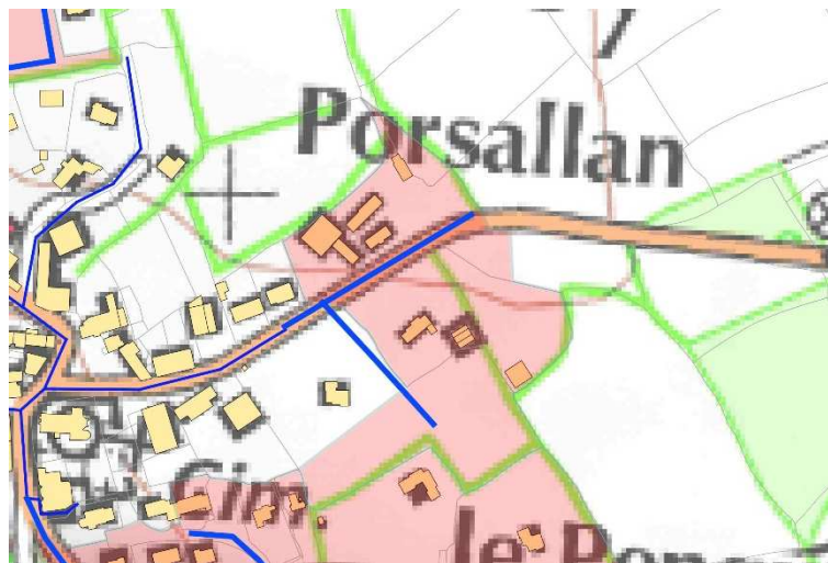
Figure 28 : projet de raccordement de la zone de Porsallan au réseau du bourg de Saint Eloy
